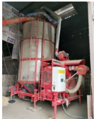
Зерносушилка в работе
