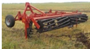
Опорные трубчатые катки
